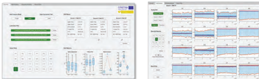
Schermate dello strumento di analisi del segnale INCardio MEA, che per facilità d'uso può essere utilizzato esclusivamente con il mouse e non richiede l'inserimento manuale dei parametri di analisi.
