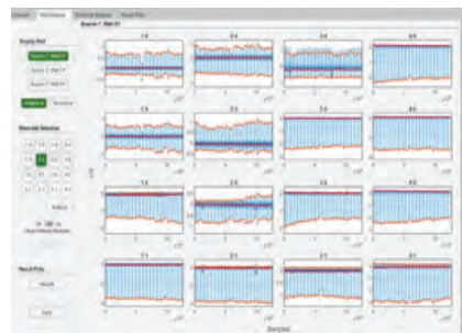
Screenshots vom INCARDIO MEA-Signalanalyse-Tool, das aus Gründen der Benutzerfreundlichkeit ausschließlich mit der Maus bedient werden kann und keine manuelle Eingabe der Analyseparameter erfordert
